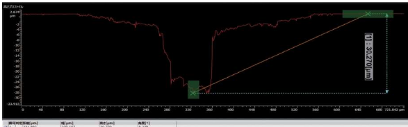
스테인리스강의 부식 / 높이 측정(MPLAPON20XLEXT / 3x3 스티칭)
