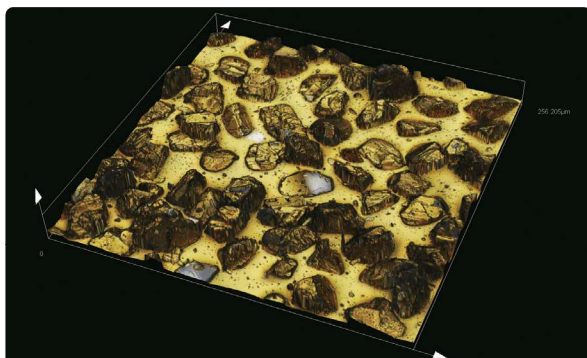
미세바늘 / 형상 평가(프로파일 측정) (MPLAPON50XLEXT / 6 × 6 스티칭)
